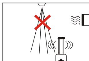
Non installare in direzione di fonti di calore o condizionatori d'aria
