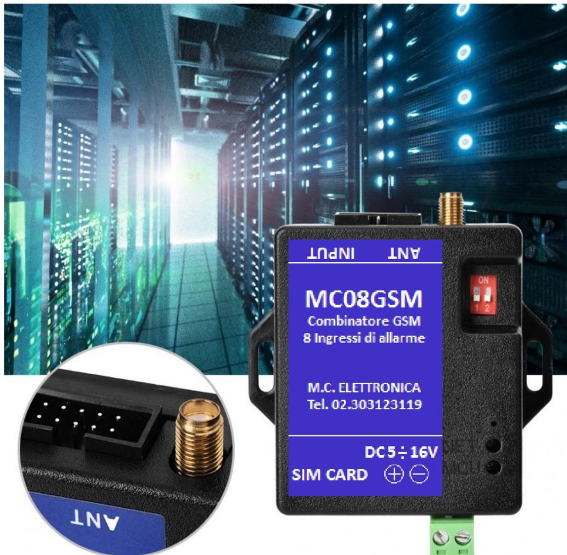
Non ci sono limiti di utilizzo del Combinatore GSM MC08GSM. Installando rivelatori volumetrici antifurto, Rivelatori di fumo, Rivelatori di umidità, rivelatori termici, ecc... potrete sfruttare gli 8 ingressi del combinatore telefonico per ricevere le notifiche individualmente, e sapere subito quale rivelatore ha causato l'allarme. Altra applicazione importante del combinatore MC08GSM è quella del controllo dei Data Center.
