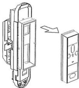
Rimuovere il coperchio della base di alloggiamento del trasmettitore.
