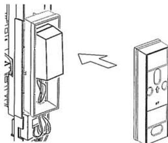
Dopo aver fatto passare i cavi dalla base dell'alloggiamento del trasmettitore all'unità. Chiudere con il coperchio la base di alloggiamento del trasmettitore.
