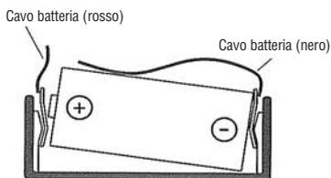
Quando l'alimentazione del BX-80NR è prelevata dalla batteria del trasmettitore, usare i CAVI BATTERIA a corredo. Inserire ogni terminale tra la batteria e il contatto di alimentazione sul porta batteria.
