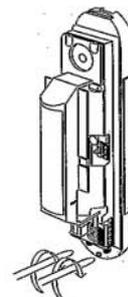
Innestare la base sulla piastra ed avvitare a fondo le viti di blocco.
