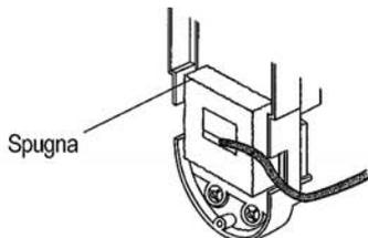
Far passare i conduttori attraverso l'apposito foro nella parte bassa dell'apparecchiatura e collegarli alle morsettiere. Sigillare con la spugna il passaggio cavi per una valida protezione contro insetti, pioggia e polvere.
