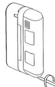
Montare il coperchio ed effettuare la prova movimento. Dopo aver completato la prova avvitare a fondo la vite del coperchio.
