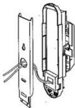
Portare i conduttori attraverso l'apposito foro e collegarli alle morsettiere (vedere Sez. 6). Assicurarsi di mettere i cavi tra le spugne della base e la piastra di fissaggio per evitare il passaggio di pioggia, polvere ed insetti.
