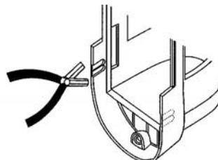
Togliere con delle pinze le paratie a sfondare per consentire il passaggio dei cavi esterni lateralmente all'apparecchio. Dopo il cablaggio, fissare l'unità alla piastra.
