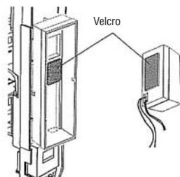
Utilizzare il VELCRO per fissare il trasmettitore alla base del suo alloggiamento.
