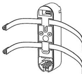
Utilizzare le fascette metalliche per fissare l'unità. Preparare le fascette sull'unità come disegno (Massima dimensione fascetta Larghezza mm 20 / Spessore mm 0,5)
