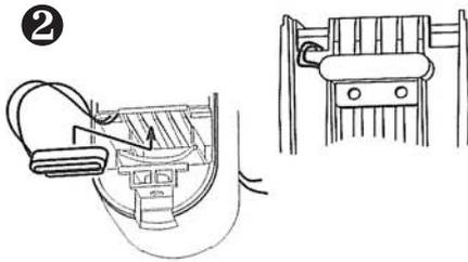
Il contatto magnetico con il suo cavo deve essere fissato sul fondo della base posteriore del BX-80NR.
