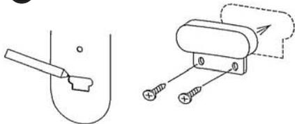
Utilizzare la DIMA DI FORATURA per segnare e determinare dove deve essere installato il magnete.
