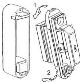
Dopo aver cablato il trasmettitore nell'unità occorre montarlo utilizzando le 2 viti. Innestare l'unità sulla base posteriore ed avvitare a fondo le 2 viti di blocco.
