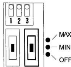
Regolare il livello audio per la funzione "allarme udibile" (vedi Sezione 8-4) e/o per il modo "controllo area" (vedi Sezione 8-3). Se nessuna funzione viene usata selezionare OFF.
