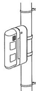
Montare l'unità, tramite le fascette metalliche, su un palo ben fissato
