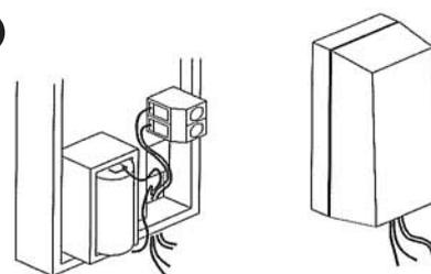
Utilizzare il cavo d'allarme a corredo per collegare i morsetti di ingresso allarme del trasmettitore. Richiudere il trasmettitore.
