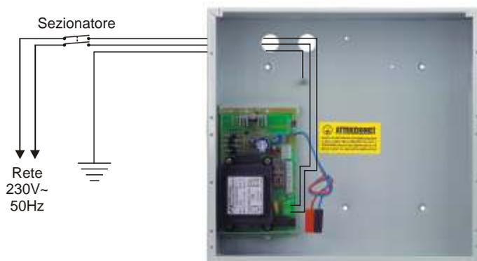
Ad impianto ultimato, collegare alla batteria i due conduttori muniti di capicorda tipo *faston* provenienti dall'alimentatore. Fare attenzione alla polarità di collegamento (Rosso = [+] positivo batteria / Nero = [-] negativo batteria), onde evitare di danneggiare in modo serio i dispositivi collegati.
