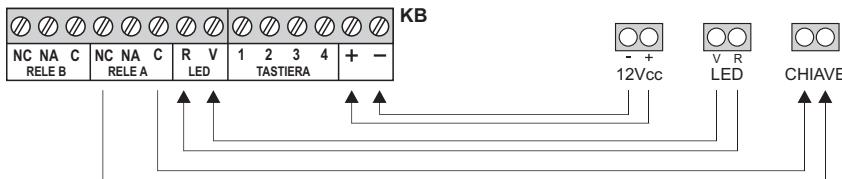
**Esempio di collegamento con le centrali di automazione cancelli**
