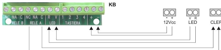
Fonctionnement **MONOSTABLE** avec centrales d'automatisation
