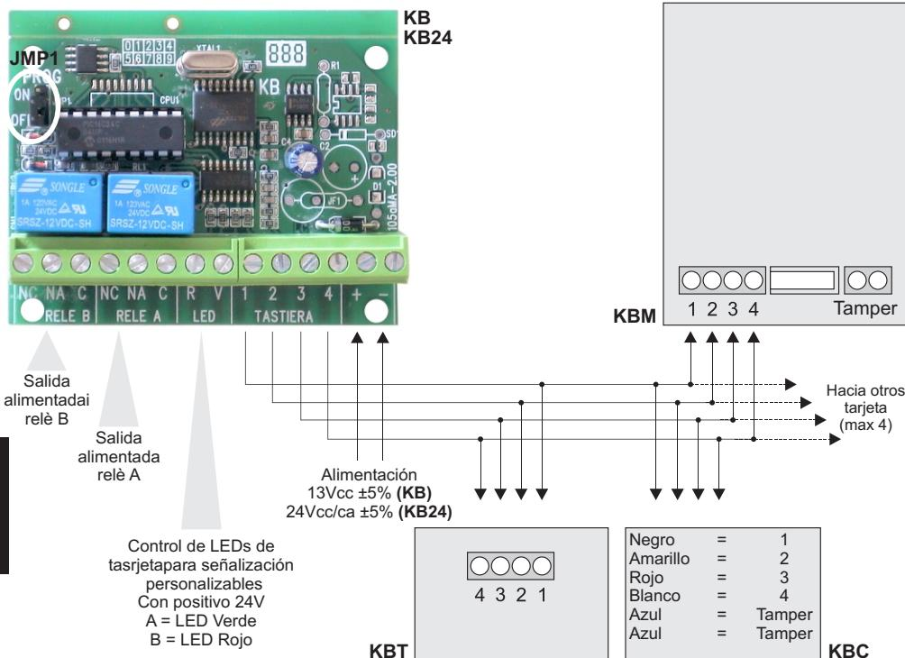
El KB24 es un sistema de comando con un teclado electrónico capaz de pilotar dos salidas relé mediante dos códigos personalizables de manera independiente o combinada. Se puede emplear para introducir y retirar instalaciones de alarma, para controlar accesos y para cualquier aplicación que precise un mando fiable, seguro y de sencilla instalación y utilización.
