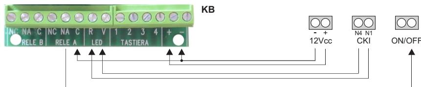
**Ejemplo de conexión con la central antirrobo Serie TM y Serie PROTEC (esc. PROTEC5X)**
