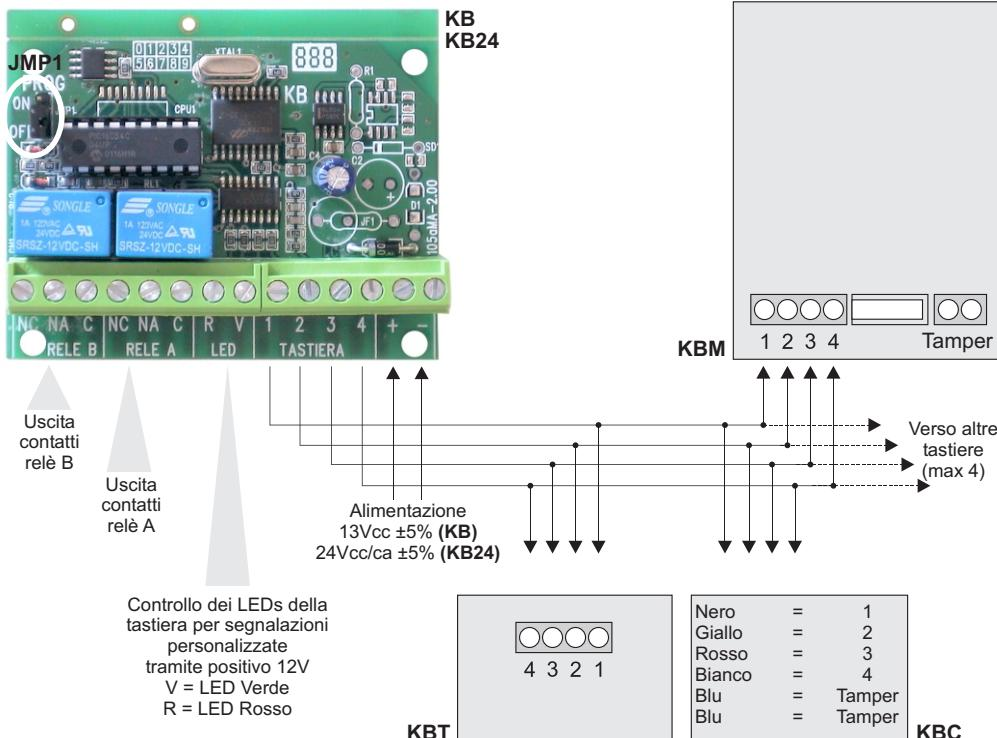
KB24 è un sistema comando con tastiera elettronica in grado di pilotare due uscite relè tramite due codici personalizzabili in modo indipendente o combinato. E' utilizzabile per inserire e disinserire impianti d'allarme, per controllo accessi e tutte le applicazioni che richiedono un comando affidabile, sicuro e semplice da installare ed utilizzare.
