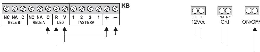
**Esempio di collegamento con le centrali antifurto Serie TM o Serie PROTEC (escl. PROTEC5X)**
