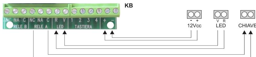
**Ejemplo de conexión con la central con las centrales d'automation ti rayes**
