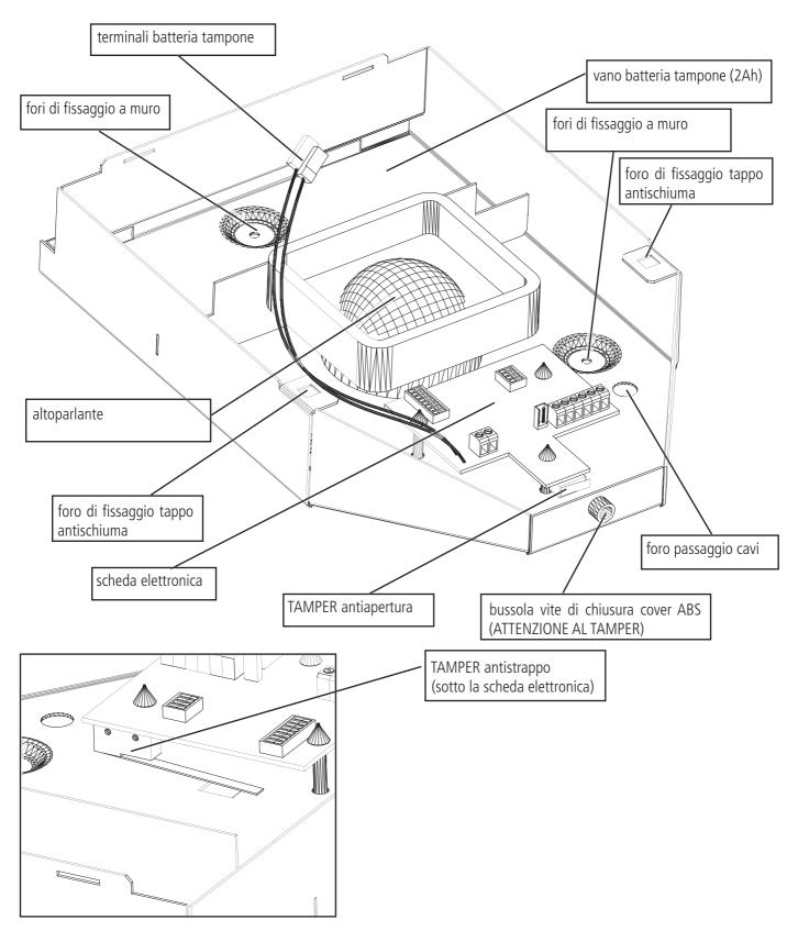
L'installazione a norma prevede l'utilizzo di una vita fissata a muro, la cui testa andrà a premere il microswitch antirimozione, posizionato sul lato inferiore della scheda.
