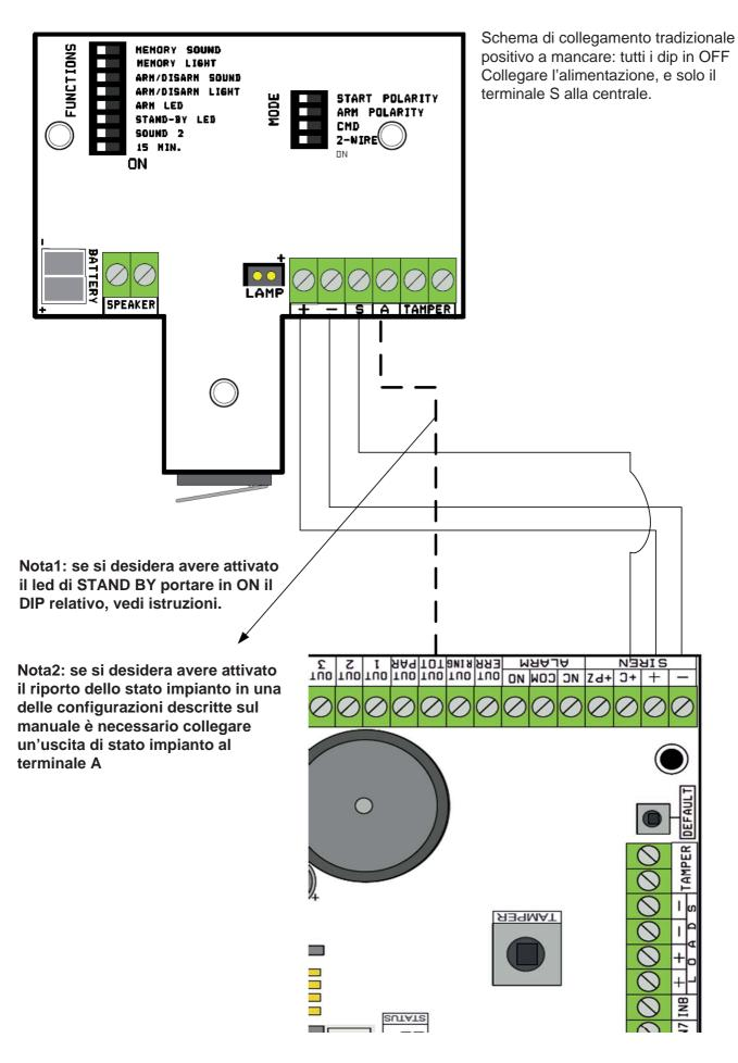
Nota: Per ottenere tutte le visualizzazioni di stato centrale, (inserito/disinserito, memoria allarme ecc.) è necessario che la sirena abbia collegato l'alimentazione (+ -) di ricarica batteria. Quando viene a mancare, (funzionamento solo in batteria) la sirena non attiverà tali segnalazioni per una questione di ottimizzazione dei consumi. Mentre il lampeggio in caso di allarme è sempre garantito.
