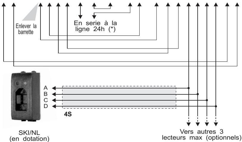
(\*) Cette connexion est optionnelle et prévoit l'activation de la protection anti-sabotage 24h si une fausse clé est introduite dans le lecteur.
