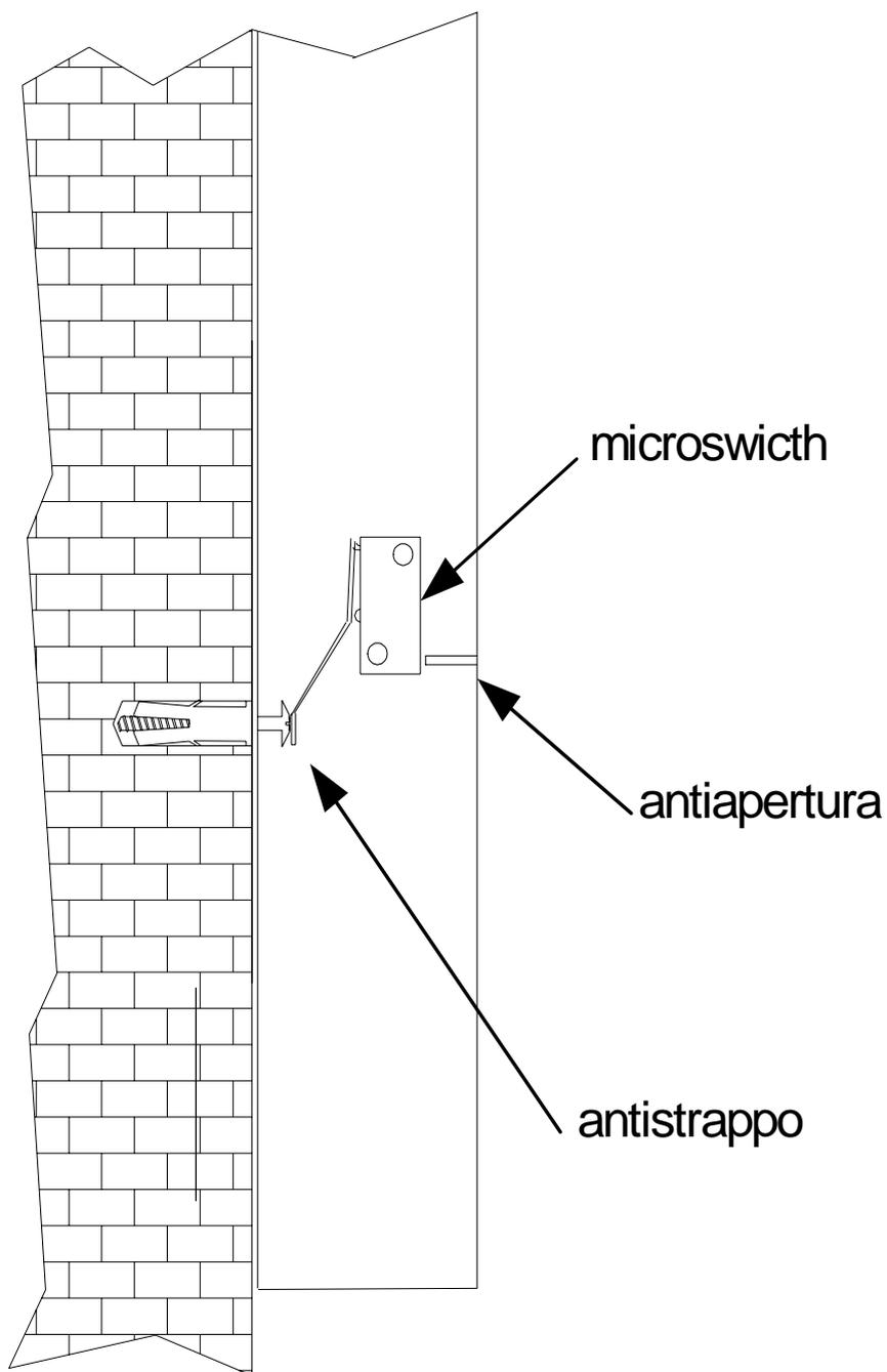
**Nota:** per ottenere la protezione antirimozione e antistrappo è necessario fissare una vite sulla parete al quale è fissato il contenitore del combinatore, in tal modo si mantiene chiuso il contatto di protezione.
